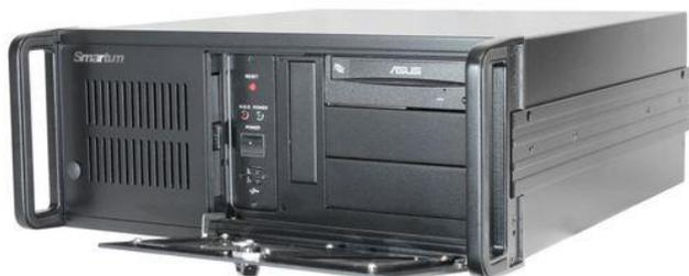
Промышленный компьютер Smartum Rack-43W2-W в стальном корпусе высотой 177 мм собран на базе процессорной платы стандарта PICMG 1.3 и объединительной платы, что даёт максимальную гибкость в плане возможностей установки плат расширения и планок с разъёмами. Конфигурация на базе процессора Core i5-10500 и RAID-массива 2 x 1 Тб. В компьютере установлен резервированный блок питания.
