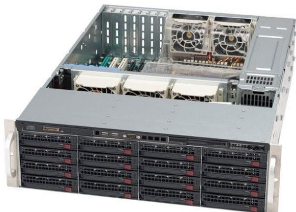
Система хранения данных Smartum Server-30C16 в корпусе высотой 132 мм (3U). Стандартная конфигурация на базе процессора Xeon E3-1230 v6 и PCH Intel C236. Сервер оснащен RAID-массивом из 16 x SATA HDD и резервированным блоком питания. Диски массива размещены в корзине с поддержкой горячей замены.
