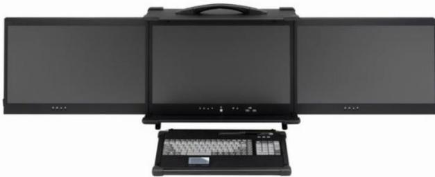
Переносная рабочая станция Smartum Portable-21271-3 оснащена тремя дисплеями диагональю 21 дюйм и разрешением Full HD, что дает возможность оператору одновременно получать и анализировать большой объем графической информации. За формирование изображения на трех независимых дисплеях отвечает видеокарта Nvidia GeForce GTX 1050. Станция использует процессор Core i7-7700, позволяющий работать с ресурсоемкими приложениями.
