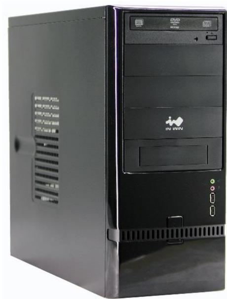
Компьютер Smartum Desktop -251. Бюджетная конфигурация, собранная на базе материнской платы промышленного класса. Использование процессора шестого поколения обеспечивает совместимость с программным обеспечением на базе ОС Windows 7. Два универсальных последовательных интерфейса RS-232/422/485 с подачей питания на оконечное устройство.
