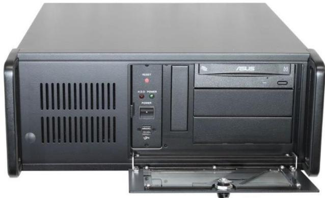
Промышленный компьютер Smartum Rack-43Q1 в стальном корпусе высотой 177 мм собран на базе процессорной платы стандарта PICMG 1.3 и объединительной платы, что даёт максимальную гибкость в плане возможностей установки плат расширения и планок с разъёмами. Стандартная сбалансированная конфигурация на базе процессора Core i5-12400.
