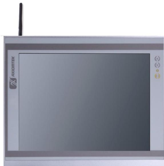
Промышленный панельный компьютер Smartum Panel-3156 с 15-дюймовым дисплеем разрешением 1024 x 768 точек. Модель с низким энергопотреблением использует процессор встраиваемого класса Atom E3827. Компьютер может дооснащаться платами расширения с шиной Mini PCI-Express.
