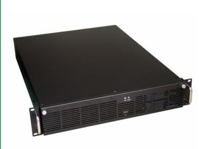
Промышленный сервер Smartum Server-2282-Н в корпусе высотой 88 мм (2U). Стандартная конфигурация на базе процессора Core i5-12400. Сервер вмещает от 2-х до 8-ми SATA HDD, оснащен накопителем M.2 SSD и блоком питания на 600Вт. Диски массива размещаются в корзине с поддержкой горячей замены.
