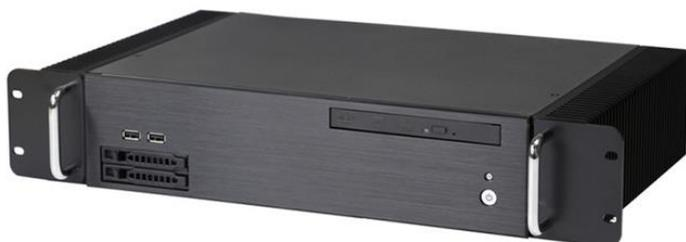
Промышленный безвентиляторный компьютер Smartum Fanless-2582 в стальном корпусе высотой 88 мм собран на базе материнской платы форм-фактора micro-ITX. Компьютер оснащается чипсетом R680E и процессором 12-ого поколения Core i5-12500T. За счет продуманной безвентиляторной системы охлаждения, не издает шума.
