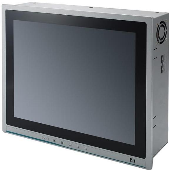
Промышленный панельный компьютер Smartum Panel -1157-PCI-G2 с 15-дюймовым дисплеем разрешением 1024 x 768 точек.
