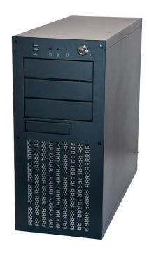
Компьютер Smartum Desktop -281. Конфигурация, собранная на базе материнской платы промышленного класса. Использование процессора тринадцатого поколения обеспечивает высокую производительность. Два универсальных последовательных интерфейса RS-232/422/485 с подачей питания на оконечное устройство.
