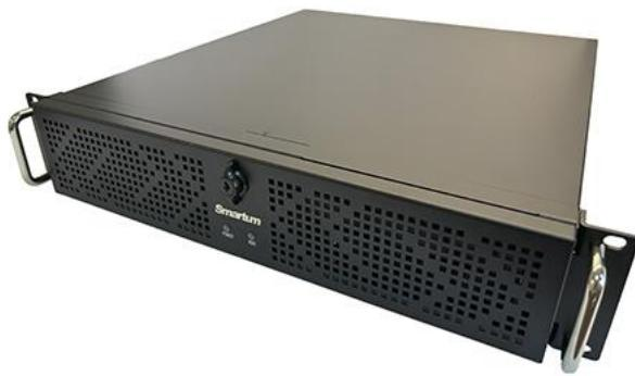
Промышленный компьютер Smartum Rack-2284-W собран в стальном корпусе высотой 88 мм на базе материнской платы форм-фактора ATX. Стандартная сбалансированная конфигурация на базе процессора двенадцатого поколения Core i7-13700.
