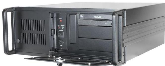
Промышленный компьютер Smartum Rack-4221 собран в стальном корпусе высотой 177 мм на базе материнской платы форм-фактора ATX. Сборка на базе процессора двенадцатого поколения, так же установлена память стандарта DDR5-4800 объёмом 8Гб. Два последовательных интерфейса поддерживают стандарты RS-232/422/485, а общее число COM-портов может быть легко увеличено с 2 до 6 при помощи добавления планок с разъемами.
