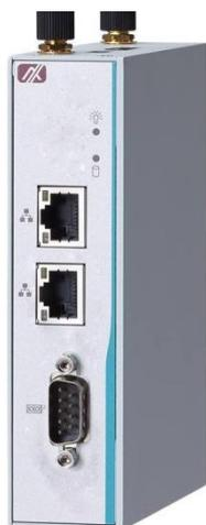
Компьютер Smartum IoT-120 относится к классу IoT-шлюзов, миниатюрных устройств с невысокой стоимостью и малым энергопотреблением, предназначенных для удаленного сбора данных, контроля датчиков и управления локальными устройствами. Она из самых малогабаритных модель в линейке продуктов Smartum.
