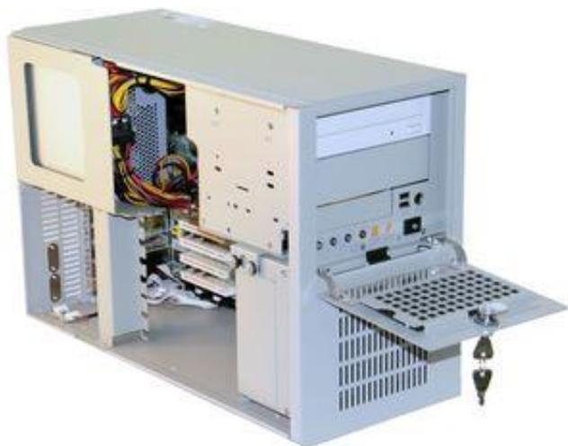
Рабочая станция оператора АСУ Smartum Desktop - 2Q1-S собрана в стальном корпусе промышленного класса с дверцей на передней панели, которая защищает внутренний объем компьютера от пыли, а органы управления и индикаторы – от механических повреждений. Станция оснащена двумя портами RS-232/422/485, а общее число последовательных интерфейсов может достигать 6.
